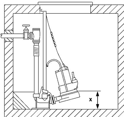
**Montáž:** Nohu spojky pomocou hmoždiniek upevnite na dno zbernej šachty a potom namontujte klzné rúrky. Potom zabudujte výtláčné potrubie vrátane potrebných armatúr ako je spätná klapka a posúvač.
