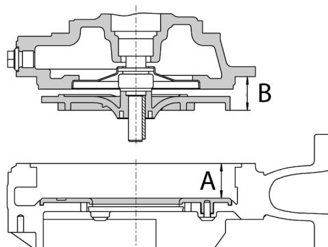
6. **Avviso!** La distanza della girante A-B deve essere di 0,5-0,7mm. Se la distanza dovesse essere superiore o inferiore, si dovrà compensare con rondelle di spessore (12x16x0,2) dietro alla girante.
