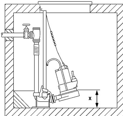
**Montaggio:** Ancorare saldamente il piede di accoppiamento al suolo del pozzo di raccolta e quindi montare le guide. Collegare il tubo di mandata con le dotazioni necessarie, valvole di ritorno e valvola a saracinesca.
