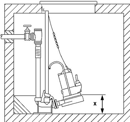
**Montage:** De koppelingsvoet stevig met pluggen op de bodem van de verzamelput vastzetten en vervolgens de schuivende buizen monteren. Vervolgens de drukleiding met de nodige hulpstukken zoals terugslagklep en afsluiter monteren.
