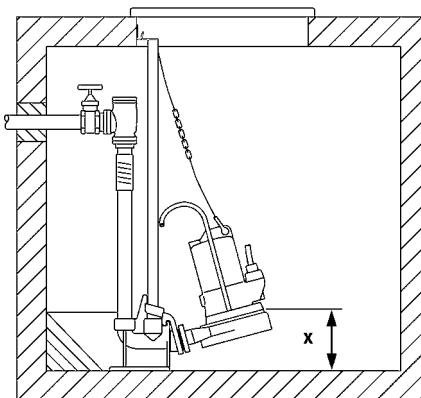
**Montage:** Cheviller fermement le pied d'assise au fond de la chambre collectrice puis monter les tubes de glissement. Ensuite, installer la conduite de refoulement y compris les accessoires de tuyauterie tels que le clapet anti-retour et la vanne d'arrêt.
