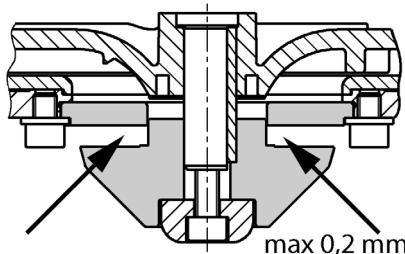
1. Den Schneidrotor mit einem Holzstück blockieren und die zentrale Innensechskantschraube herausdrehen.
