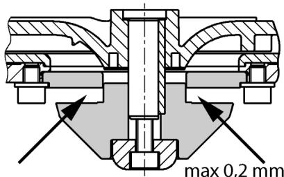
1. Se blochează rotorul de tăiere cu o bucată de lemn și se desface șurubul hexagonal central.
