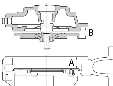
4. Aan elke schoep de afmeting B bepalen en de grootste waarde noteren.
