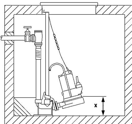
**Montaż:** Przymocować kotwami stopę łączącą na posadzce studni kolektorowej i następnie założyć rurę styczną. Następnie dokonać montażu rurociągu ciśnieniowego, włącznie z niezbędną armaturą jak klapy zwrotne i zasuwy odcinające.
