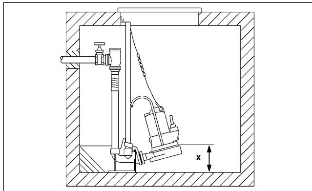
**Beszerelezés:** Erősítse fel a csatlakozolábat a gyűjtőakna padlójára, majd szerelje fel a vezetőcsövet! Azután építse be a nyomóvezetéket a szükséges armatúrákkal (például visszacsapószelep, tolózár) együtt.
